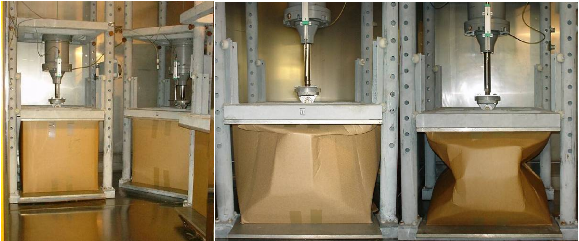
Abb. 4: Langzeitprüfung (Druckgestelle in der Klimakammer)
