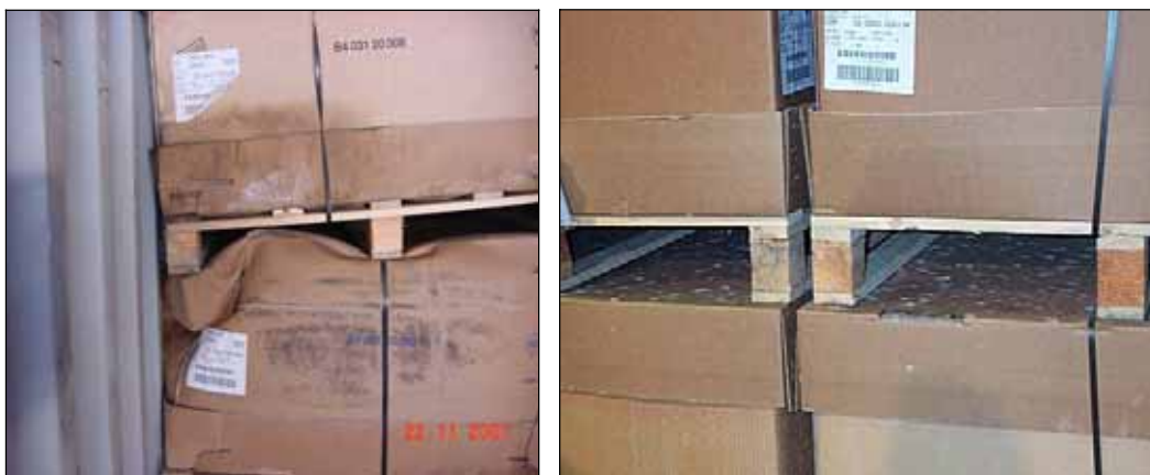
Abb. 2: Durch Feuchtigkeit beschädigte Wellpappeverpackungen mit Schimmelpilzbefall an den durchfeuchteten Bereichen Quelle: BFSV
