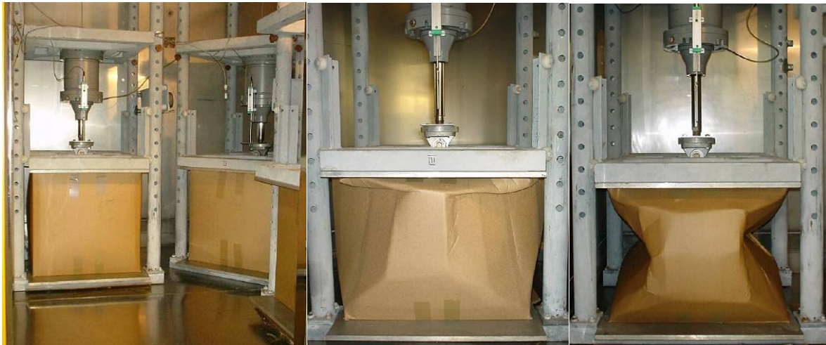
Abb. 4: Langzeitprüfung (Druckgestelle in der Klimakammer)
