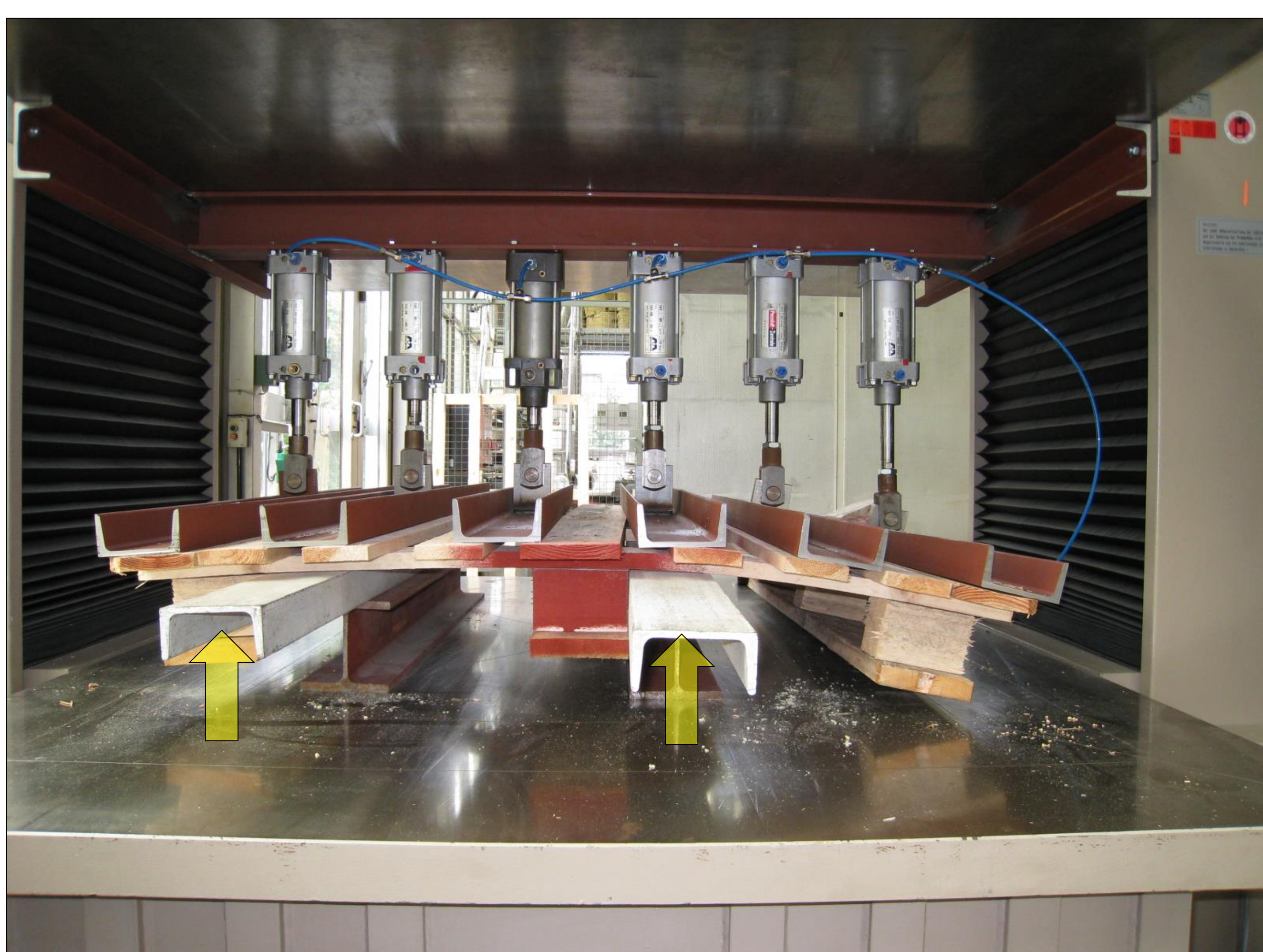
Kundenspezifische Modifikation des Prüfaufbaus zur Simulation des Umschlags mit dem Gabelstapler oder Hubwagen, Asymmetrische Lastverteilung
