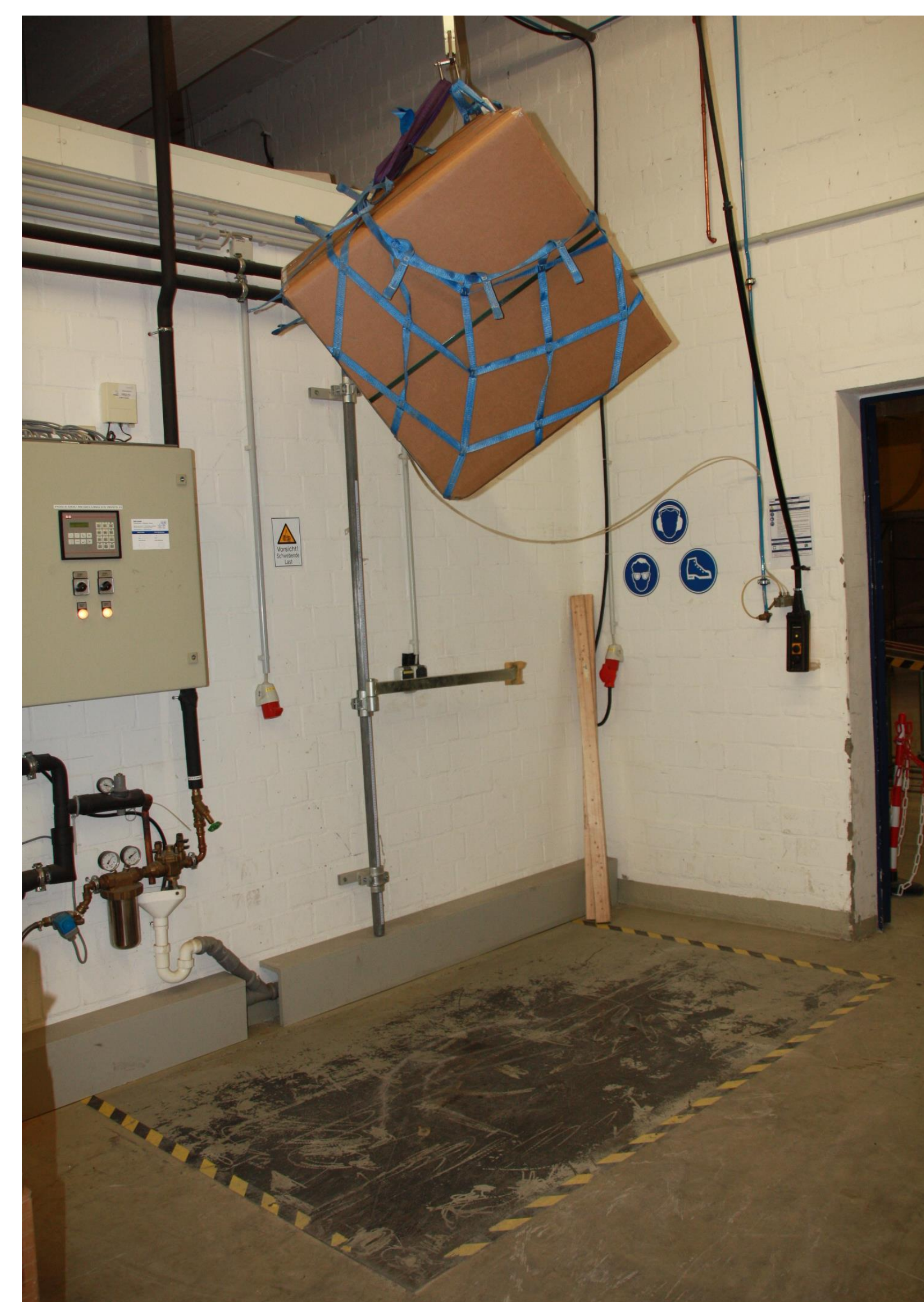
Fallprüfungen aus einer Höhe von jeweils 1,8m; auf die Seite und auf die Ecke
