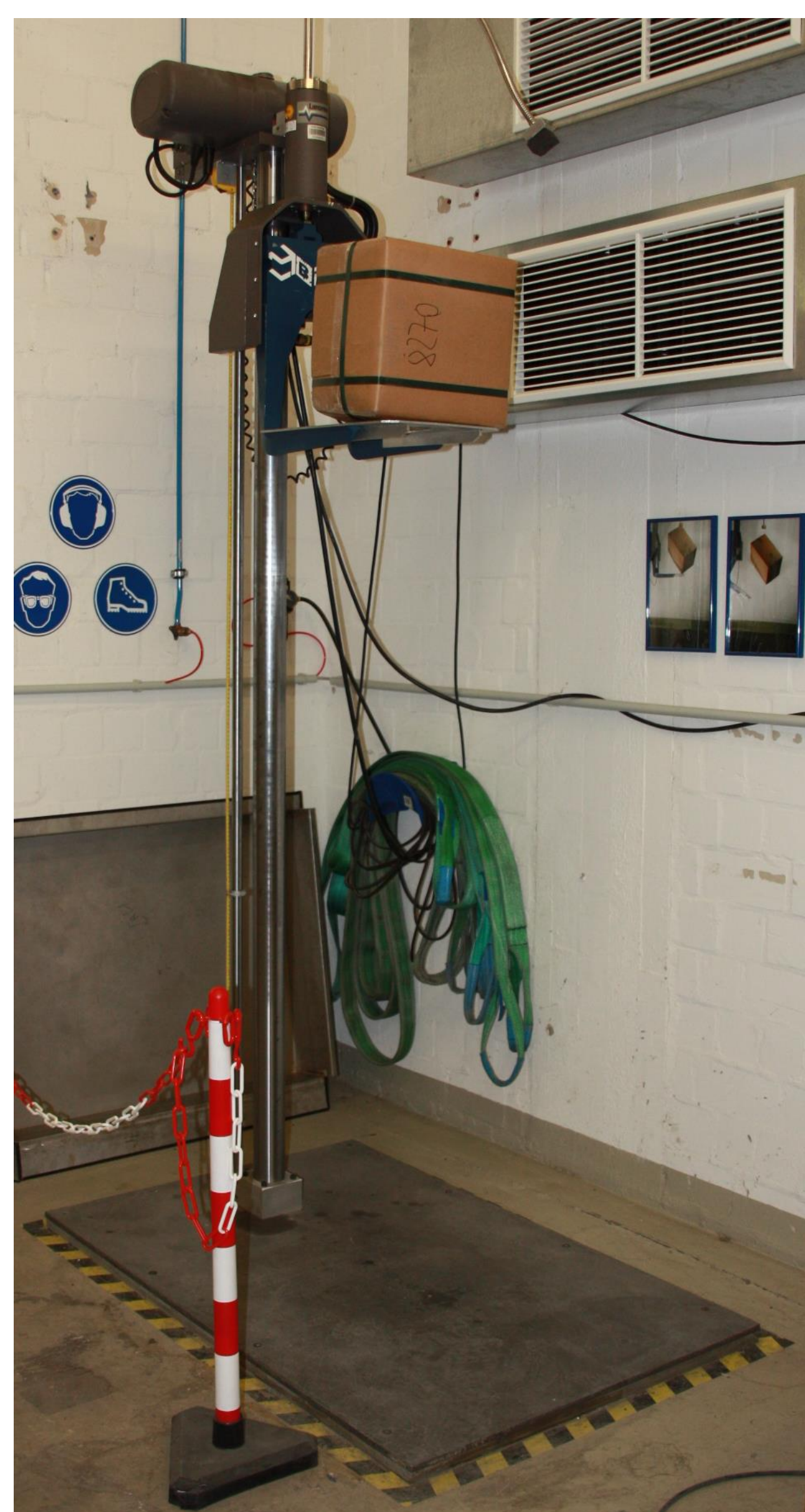
Fallprüfungen aus einer Höhe von jeweils 1,8m; auf die Seite und auf die Ecke
