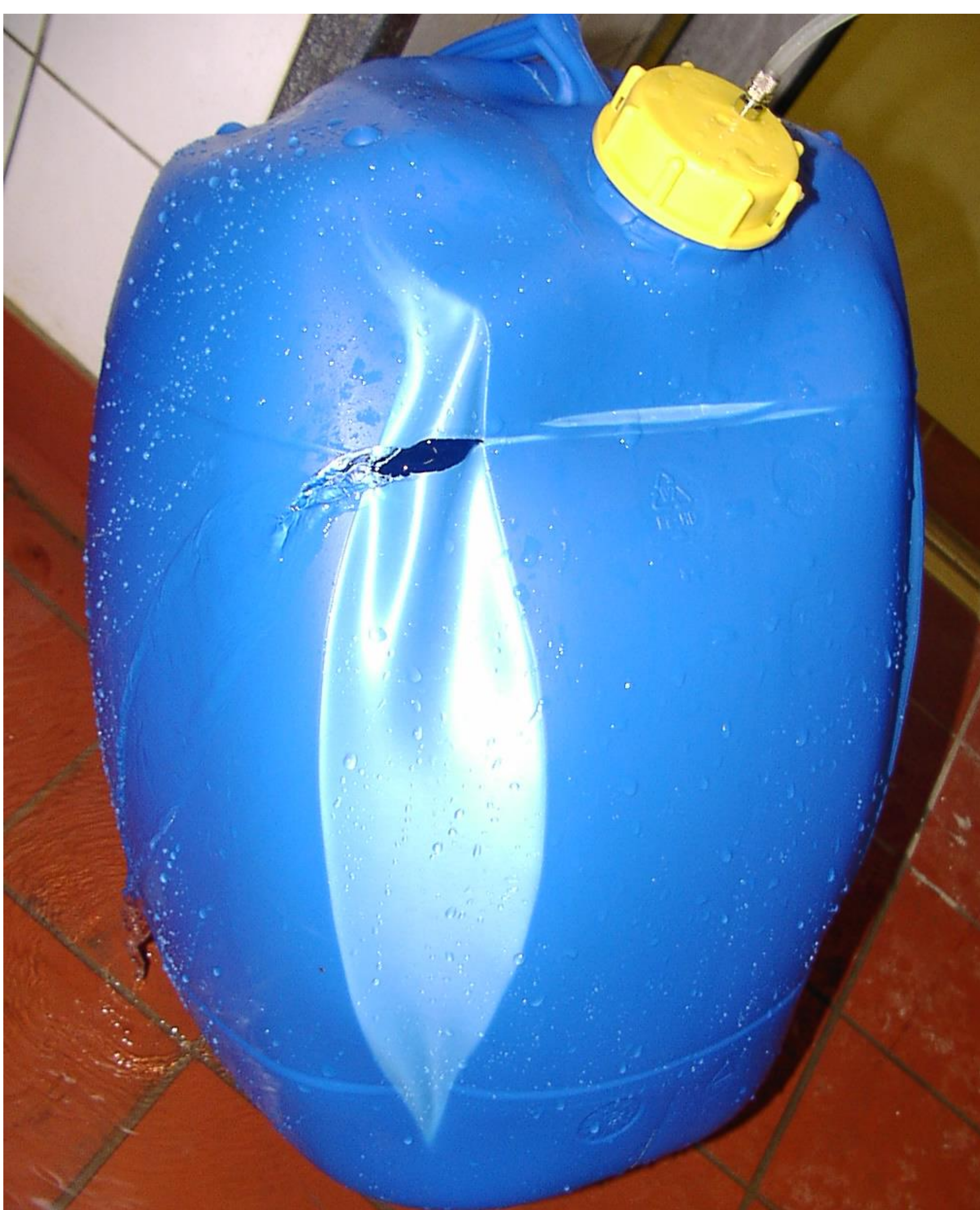
Innendruckprüfung an Kunststoffkanistern
